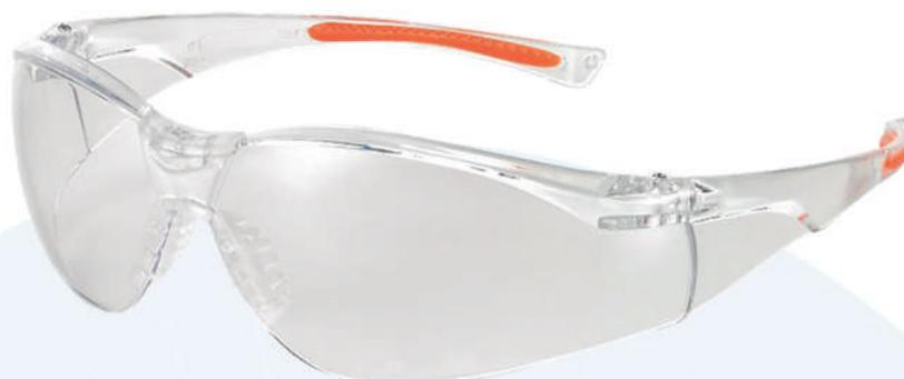
**Óculos de Segurança**, tipo lente plana, com armação e visor confeccionados em uma única peça de policarbonato disponível nas cores incolor, cinza e incolor espelhado (indoor/outdoor) com quatro pinos localizados na posição do nariz utilizados para o encaixe do apoio nasal antiderrapante, hastes tipo espátula confeccionadas do mesmo material da armação fixadas ao visor por meio de parafuso metálico com borracha antialérgica na cor laranja encaixada na parte interna das extremidades das hastes.
